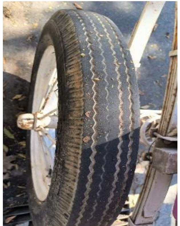
Figura 15 – Desgaste de pneu em uma charrete (EQU-38).
