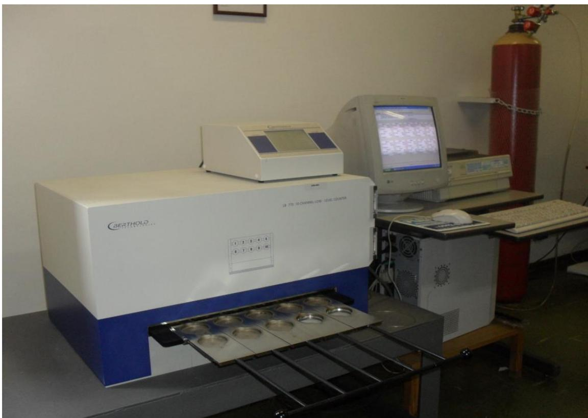
FIGURA 13 - Detector proporcional de baixa radiação de fundo e fluxo gasoso, modelo Berthold LB 770.
