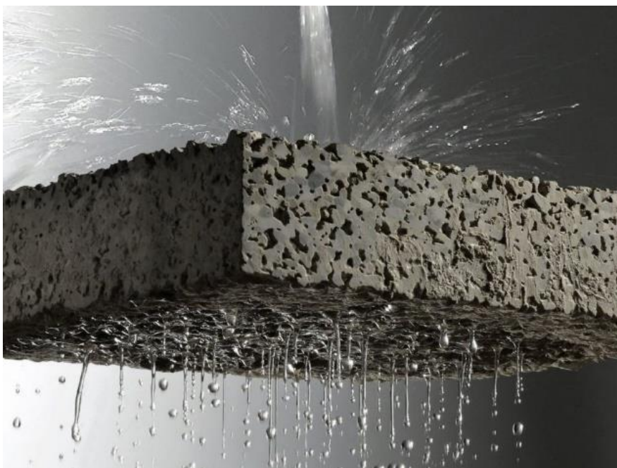
Figura 57 – Funcionamento do concreto poroso
